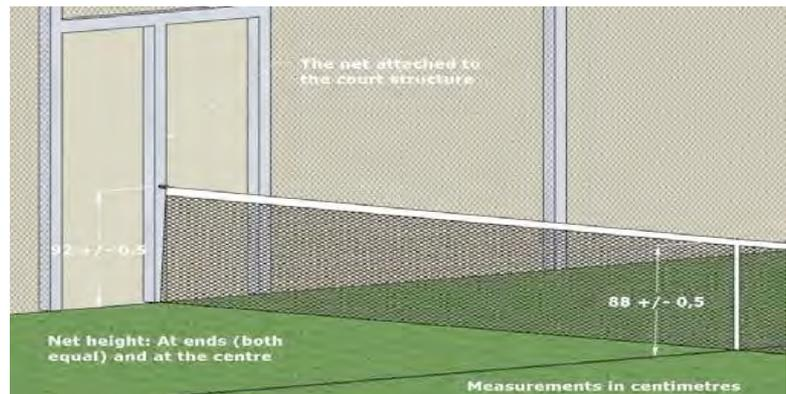
Le filet est suspendu par un câble métallique dont le diamètre maximum est de 0,01 mètre ; les extrémités du câble sont attachées à deux poteaux latéraux ayant une hauteur maximale de 1,05 mètres ou à un élément de la structure du court qui permet de suspendre et de tendre correctement le filet.
